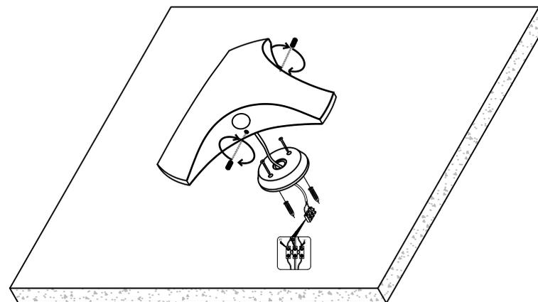
!!!Позаботьтесь, чтобы избежать повреждения любой скрытой проводки и труб. Для кирпичных и гипсокартонных стен должен использоваться соответствующий крепеж.
