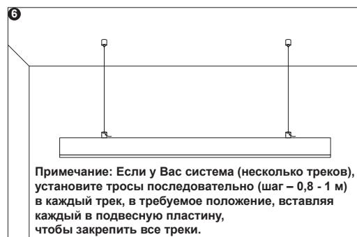
Примечание: Если у Вас система (несколько треков), установите тросы последовательно (шаг - 0,8 - 1 м) в каждый трек, в требуемое положение, вставляя каждый в подвесную пластину, чтобы закрепить все треки.
