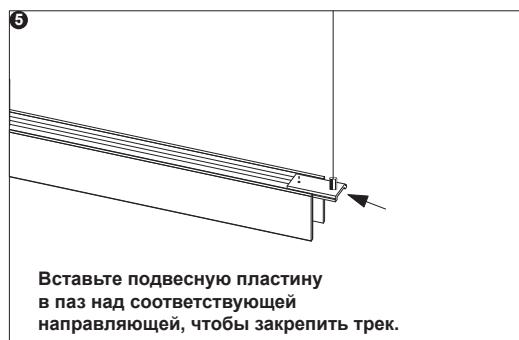
Вставьте подвесную пластину в паз над соответствующей направляющей, чтобы закрепить трек.
