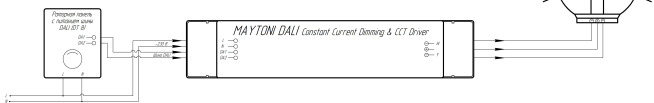
2. Схема подключения контроллера и драйвера без отдельного блока питания шины DALI (DT 8)
