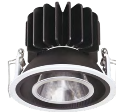
358514 IP 20 Светильник встраиваемый светодиодный Корпус алюминий/ рефлектор японский акрил 30 Вт COB 220 В 2700 Лм 4000 К Цвет LED белый Врезное отверстие Ø 115 мм Высота встраиваемой части 96 мм Угол поворота 350° Угол рассеивания 40°
