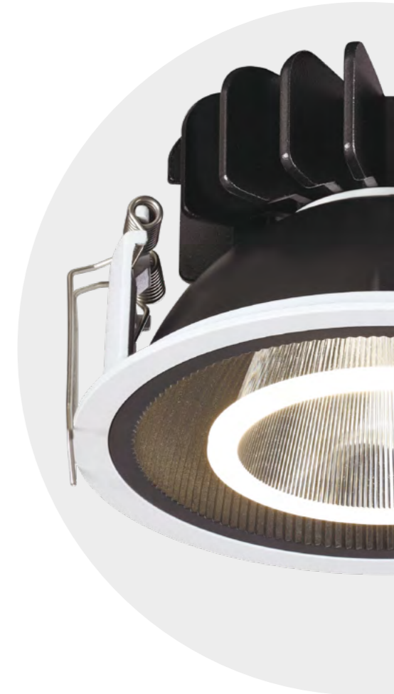
358514 IP 20 Светильник встраиваемый светодиодный Корпус алюминий/ рефлектор японский акрил 30 Вт COB 220 В 2700 Лм 4000 К Цвет LED белый Врезное отверстие Ø 115 мм Высота встраиваемой части 96 мм Угол поворота 350° Угол рассеивания 40°
