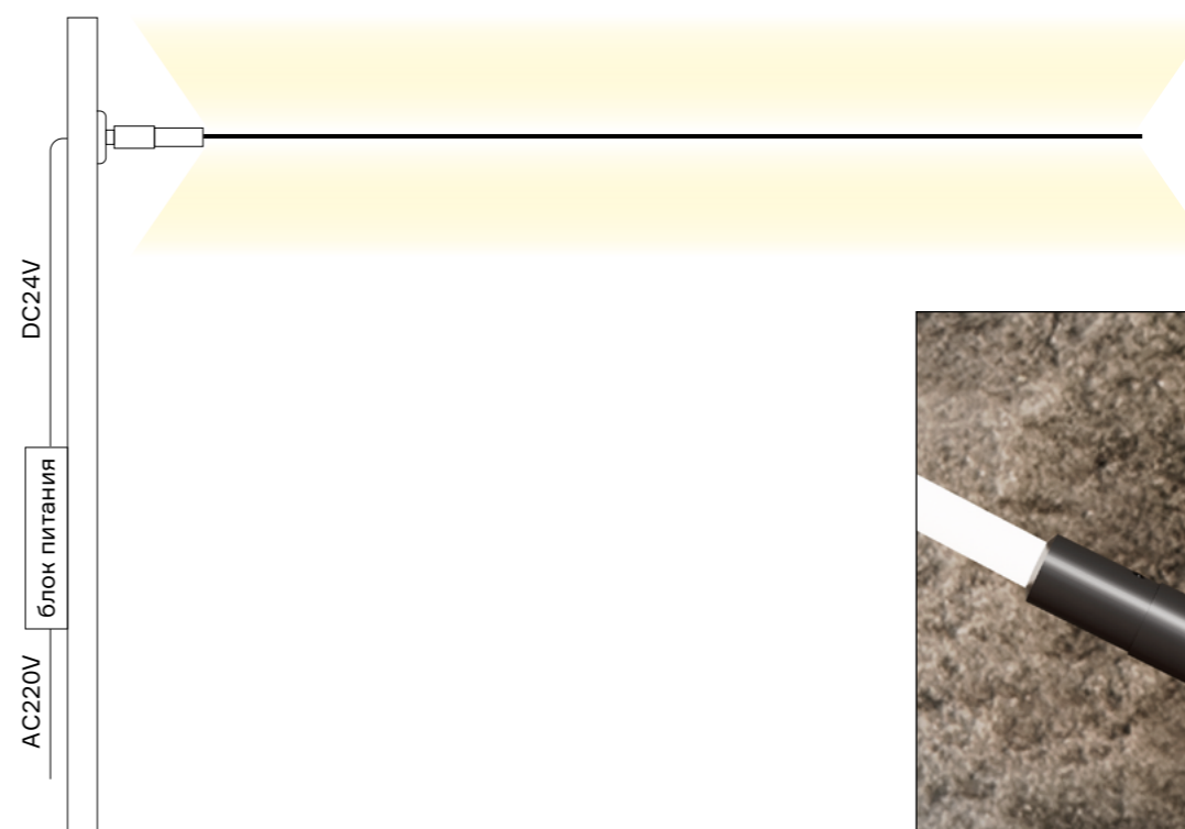
Сечение неона 13 мм x 13 мм для неона на креплениях-шарнирах
